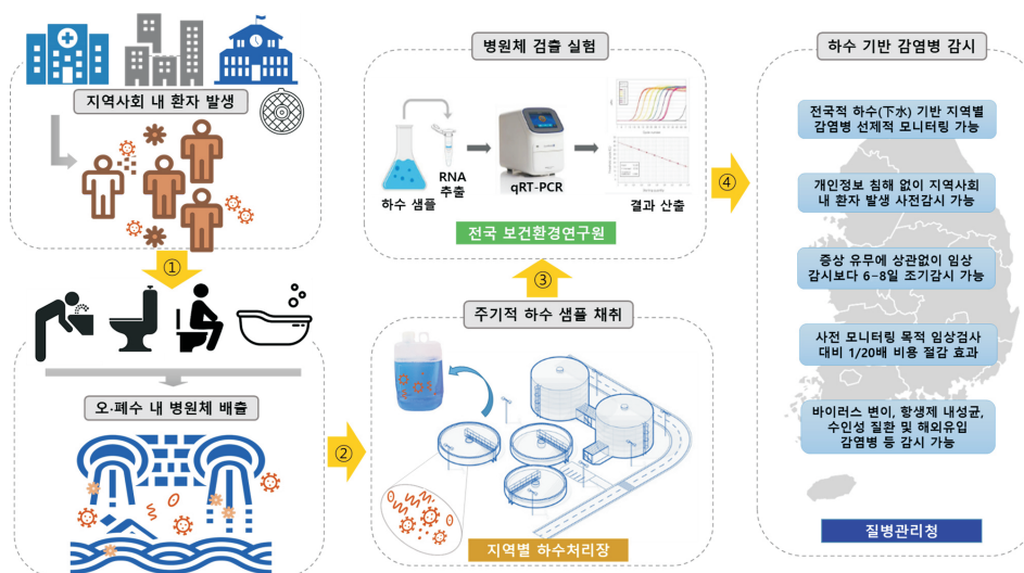
그림 1. 하수 기반 감염병 감시 사업 (KOWAS) 감시 체계 모식도 KOWAS=Korea WAstewater Surveillance.
